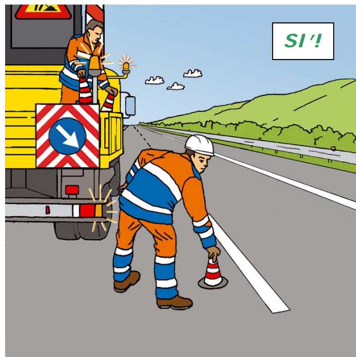
Figura 59 – Posizionamento dei coni o defleco: comportamento corretto
